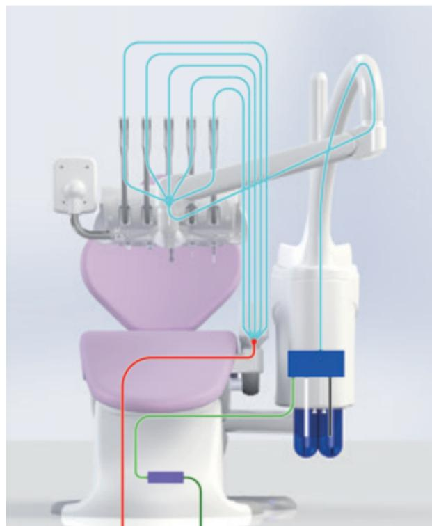
VDS (Vitali Disinfection System) è un sistema certificato per l'efficace disinfezione dei circuiti interni. Funzionamento e monitoraggio sono completamente automatici. Il top della sicurezza con il minimo sforzo.
